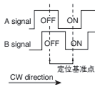
A 相及 B 相均可实现输出规定的示例
